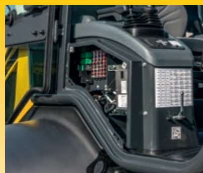
Sidedeksel for rask tilgang ved vedlikehold
